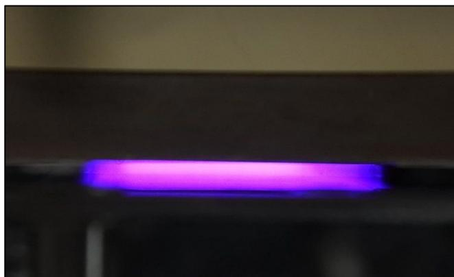
プラズマ放電が確認できましたら、処理ガス流量を確認した後、スライダックの電源スイッチを OFF、処理ガスを止めます。
