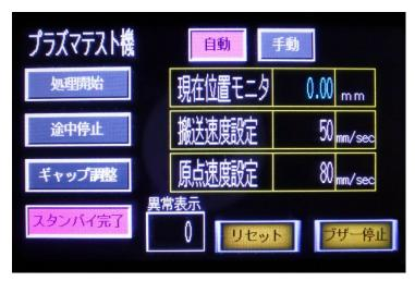
「処理開始」 …プラズマ処理を開始します。処理終了後スタンバイ位置に戻ります 「途中停止」 …処理を途中停止します。再び動作させるには「リセット」をタッチしてください 「ギャップ調整」 …可動試料台が中央(プラズマ放電部下)に移動します 「スタンバイ」 …可動試料台が手前に戻ります
