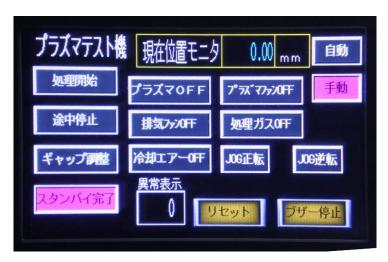
「処理開始」 …可動試料台が奥まで移動します
