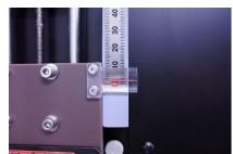
ジェット型は "ギャップ調整用スケール"の 0 点に対応しておりません。 目視もしくはスケールの中間位置から 5 ~ 1 0 mm 程度に合わせてください。
