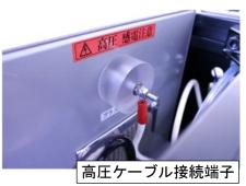
ジェット型は装置背面の接続端子台にアースケーブルが つながっています。ドライバーで外し、ケーブルを抜き取 ってください。
