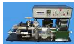
2. 高圧電動ポンプ
